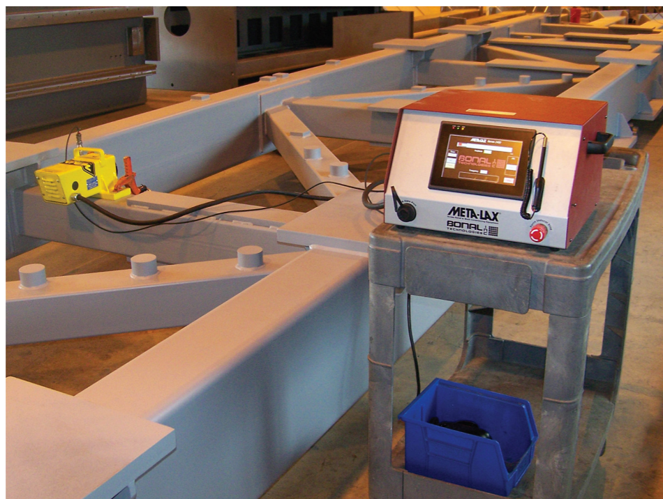
▲ Konstruksjoner opptil 2x5 meter kan behandles med en enkelt Meta-Lax-maskin. Foto: Bonal Technologies INC
