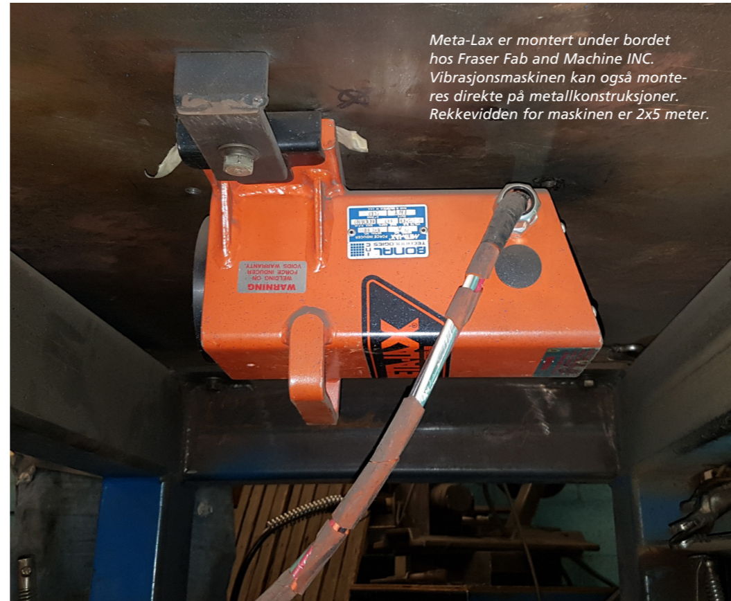
Da Fraser Fab and Machine INC i 1997 skulle lage hundre testbenker for GM, som dem på bildet, tok de i bruk Meta-Lax subharmonisk vibrasjonsteknologi. Nå, snart 20 år senere benytter verkstedbedriften fortsatt Meta-Lax til avspenning av metallkomponenter.
